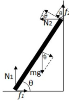
上圖為長棍受力的力圖；其中  $mg$  為重力， $N_1$  為地面所施正向力， $N_2$  為牆面所施正向力， $f_1$  為長棍與地面之間的靜摩擦力， $f_2$  為長棍與牆面之間的靜摩擦力。
