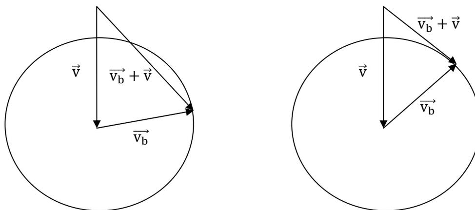
因為要求偏移距離最小，代表  $\vec{v}_b + \vec{v}$  在水流方向的分量最小， $\vec{v}_b + \vec{v}$  與  $\vec{v}$  夾角最大如上右圖，即  $\vec{v}_b + \vec{v}$  切圓於一點，所以  $2T = d / (\sqrt{v^2 - v_b^2} \frac{v_b}{v})$ ，已知
