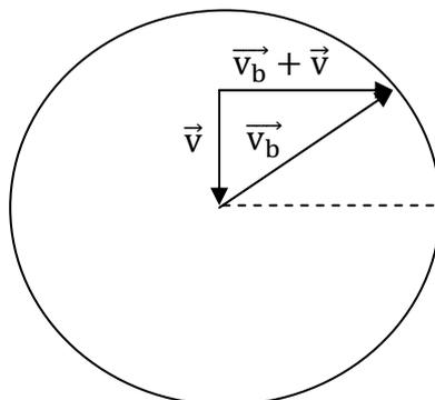
所以 $2T = d/\sqrt{v_b^2 - v^2}$ 。已知 $T = d/v_b$ ，所以 $v = \frac{\sqrt{3}}{2} \frac{d}{T}$ 。
