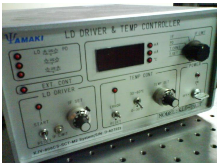
照片(7) 二極體雷射 (電源供應器)
